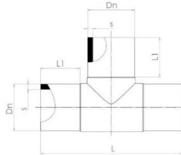
➤ 16 bar WODA , 10 bar GAZ / 16 bar WATER, 10 bar GAS / 16 бар ВОДА, 10 бар ГАЗ
