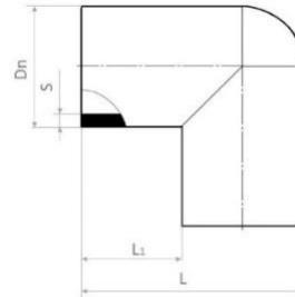
➤ 16 bar WODA , 10 bar GAZ / 16 bar WATER, 10 bar GAS / 16 бар ВОДА, 10 бар ГАЗ
