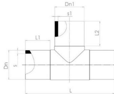
➤ 10 bar WODA , 6 bar GAZ / 10 bar WATER, 6 bar GAS / 10 бар ВОДА, 6 бар ГАЗ
